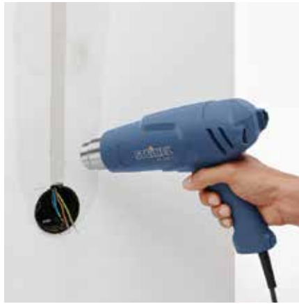
HL 1620 S Сушка. Быстрая сушка штукатурки горячим воздухом.
