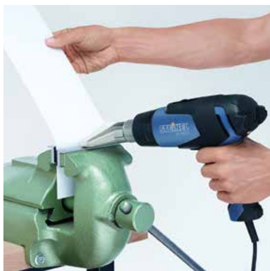
Придание желаемой формы пластику с помощью нагрева
