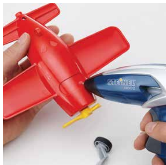
Ремонт пластиковой игрушки с помощью горячего клея
