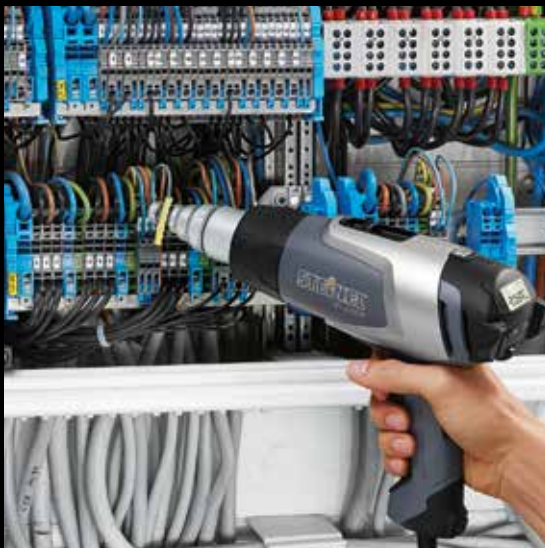
Обжим кабельных муфт в распределительном шкафу
