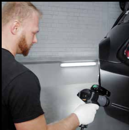
Измерение температуры и горячего воздуха одной рукой при обклейке машины
